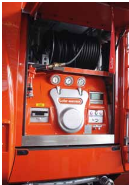
Bild 3 Ein »moderner« Pumpenbedienstand: Nichts ist auf den ersten Blick klar ...
