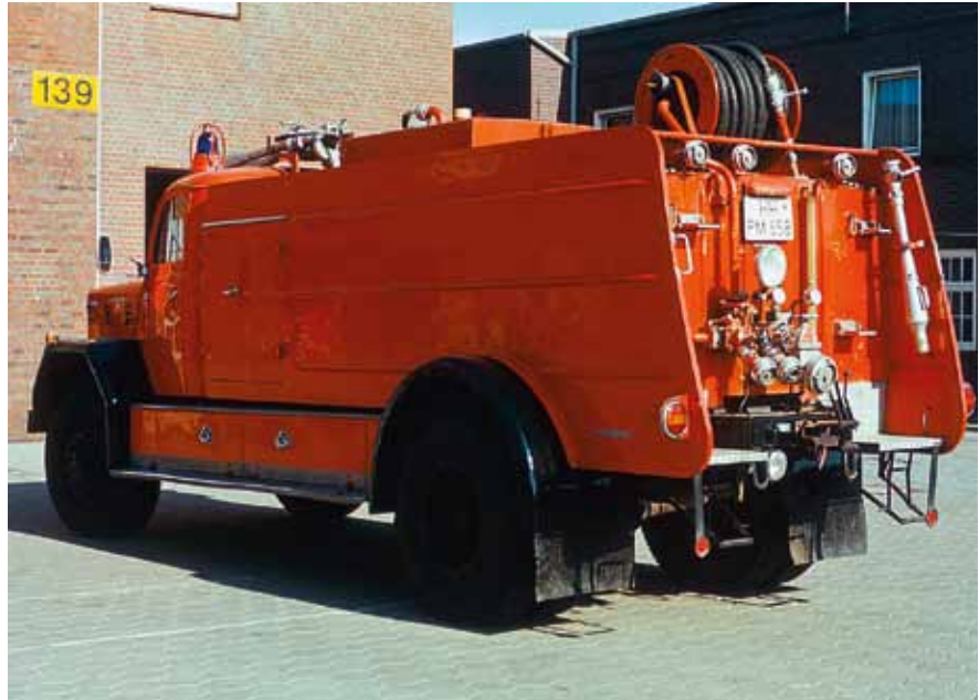
Bild 3 Ein »moderner« Pumpenbedienstand: Nichts ist auf den ersten Blick klar ...
