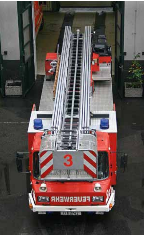
Bild 4 Hubrettungsgeräte sind komplexe technische Geräte, die ein gut ausgebildetes Bedienungsteam bestehend aus Fahrzeugführer und Maschinist benötigen.
