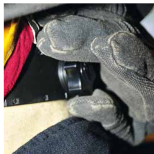
Durch Haube und Maske ist der Kopfumfang vergrößert worden: Der Helm muss angepasst werden.
