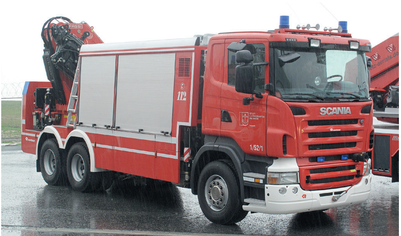
Bild 4 Ein echter Koloss ist der Rüstwagen-Kran der BF Ludwigshafen, der auf der Messe bei Rosenbauer zu sehen sein wird. Er ist auf einem dreiachsigen Scania-Fahrgestell aufgebaut und hat im Heck auf einem Drehkranz einen Bergekrane montiert. Der funkferngesteuerte Bergekrane ist um 360° endlos drehbar und erreicht eine maximale Ausladung von 24,8 m.
