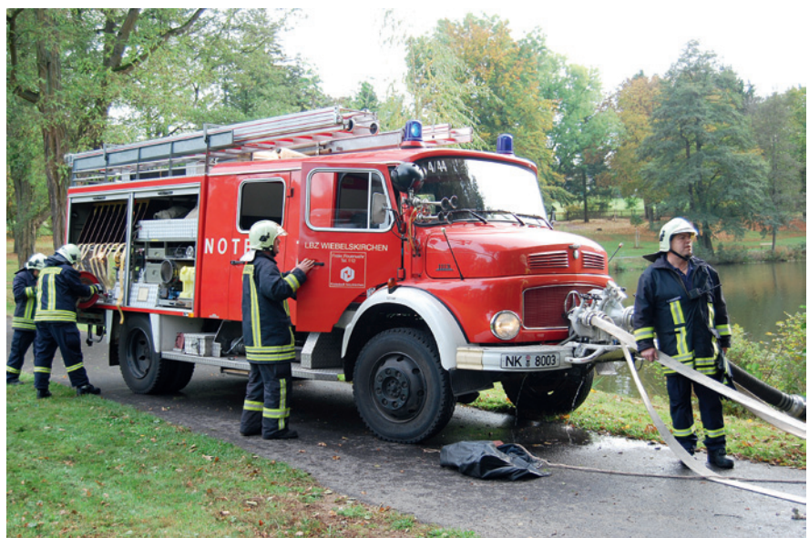
Bild 7 Wasserentnahme am offenen Gewässer mittels Vorbaupumpe des LF 16 TS (Bund) im Einsatzabschnitt »Wasser- entnahme Gutsweiher«.
