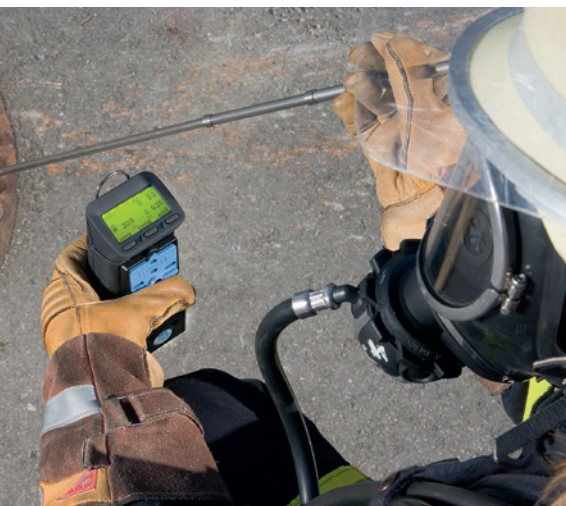
Bild 10 Freimessung in explosionsgefährdeten Bereichen mit dem funktionsgeprüften Microtector II der Firma GfG.
