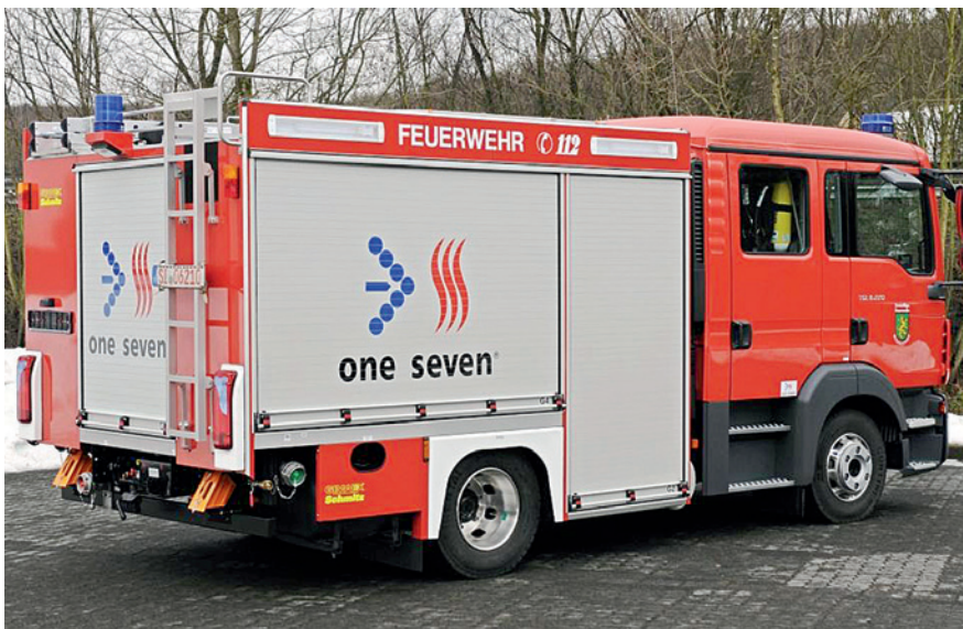
Bild 6 Im März von Gimaex-Schmitz in Wilnsdorf ausgeliefertes Staffellöschfahrzeug StLF 10-6 der Feuerwehr Rudolstadt mit One-Seven®-System und Frontmonitor zur Brandbekämpfung im Pörzberg-Tunnel in Thüringen.
